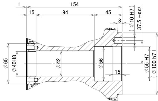
主軸断面図(S=1:2)
